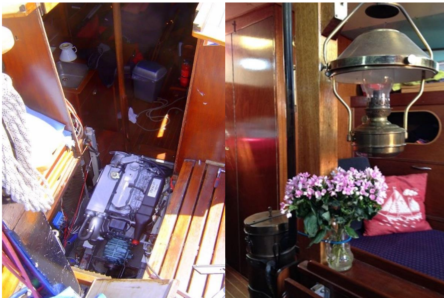
Een nieuwe motor en het scheepsinterieur met linksonder de houtskoolkachel (CO-detector aanbevolen).
