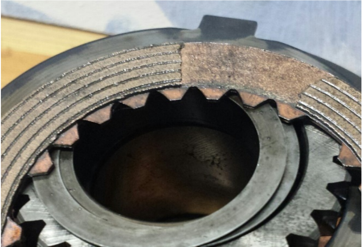
Een afgebroken frictiering.
