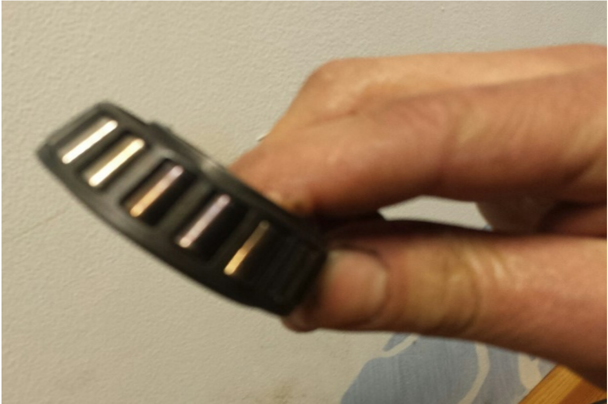
Dit lager is duidelijk oververhit geweest.
